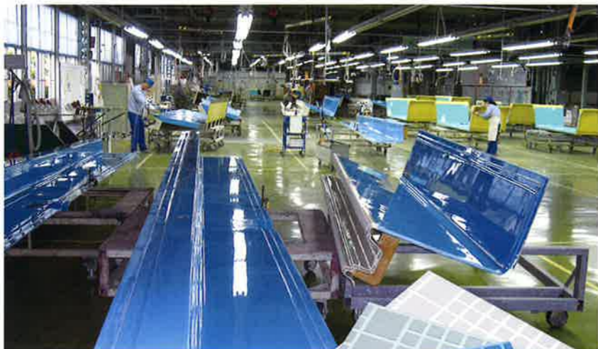
ヤマハ発動機プール事業推進部のFRP工場。ユニットの大半はこの工場で作られている。
