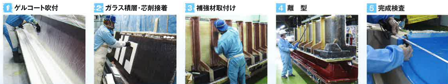
1 ゲルコート吹付 プールユニットの型となる「メ型」に表面塗装材となるゲルコートを塗布。
