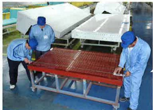
フロアの型をチェックする品質保証グループのスタッフ。この型の精度がそのままユニットの品質に反映される。安定した品質のユニット製造により、現場の組立ロスも無くなるのだ。
